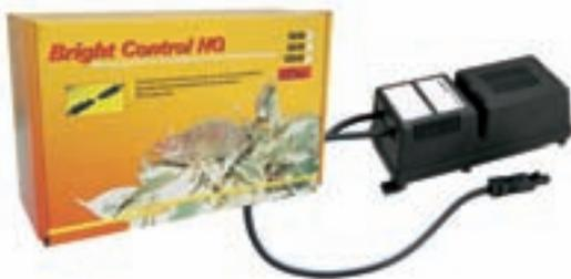
Das Bright Control HQ ist ein anschlussfertiges Vorschaltgerät für Quecksilberdampflampen wie Osram HQL. Das Vorschaltgerät ist zusammen mit einem Kondensator berührungssicher in ein Plastikgehäuse verbaut. So haben Sie auf jeden Fall eine elektrisch sichere Installation, die sofort betriebsbereit ist. Sie müssen keine Verkabelung vornehmen, eine Steckverbindung ermöglicht den einfachen Anschluss von Lampenfassungen.
