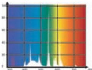
Die Daylight Sun T5 ist eine Leuchtstoffröhre, die speziell für die Ausleuchtung von Terrarien entwickelt wurde. Auf UV-Strahlung wurde bewusst verzichtet, stattdessen wurde die Röhre auf höchste Lichtleistung ausgelegt.
